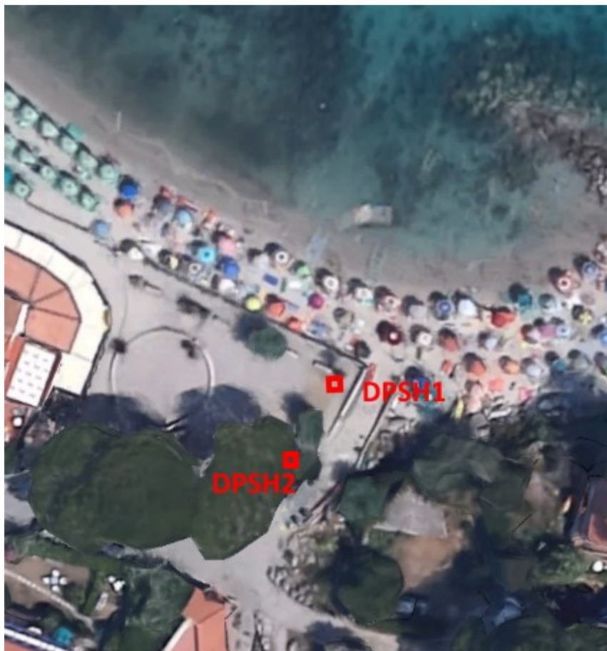
Fig. 6 Ubicazione delle prove penetrometriche
