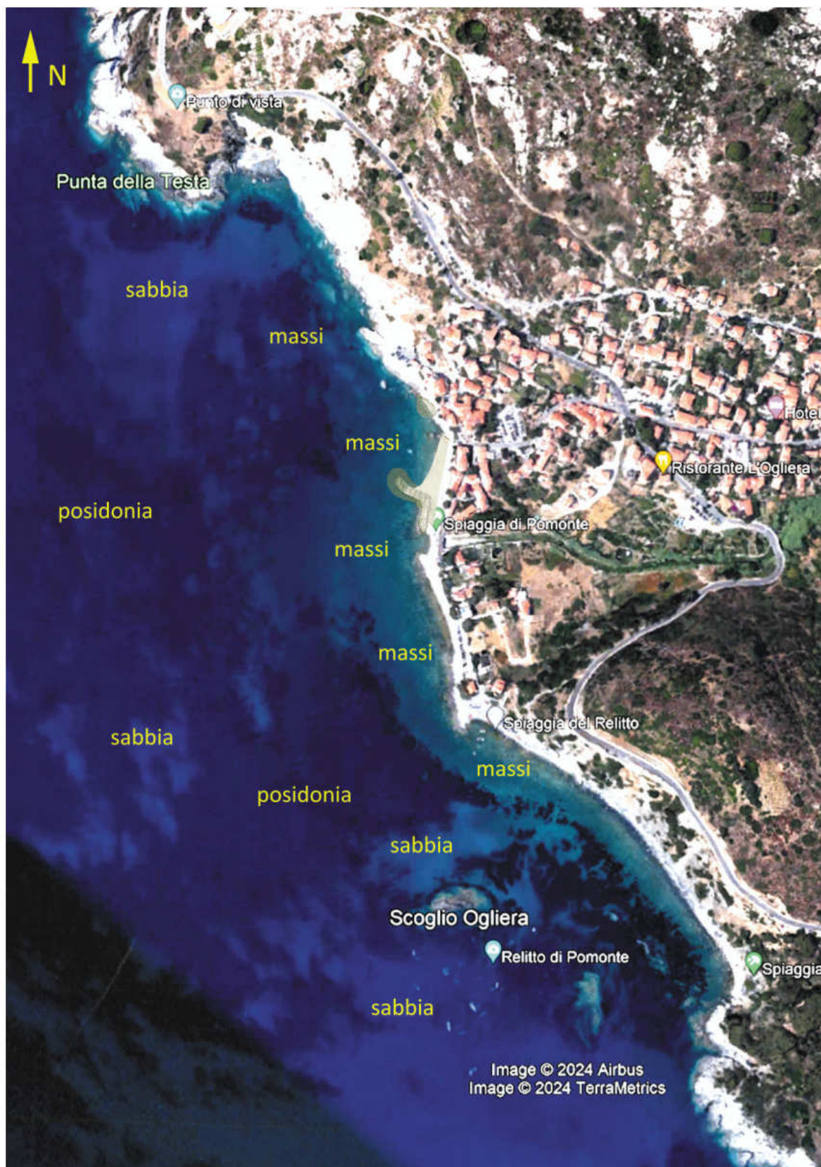
Fig. 11 – Il fondale davanti a Pomonte in una foto satellitare, molto contrastata per risaltarne la composizione dei fondali e la prateria di Posidonia. Le opere di progetto (pennello e barriera radente) occupano una porzione minima della spiaggia sommersa più prossima alla riva. E si tratta di massi che si sovrappongono a massi, o ghiaie che si aggiungono a ghiaie, perfettamente compatibili e sovrapponibili.
