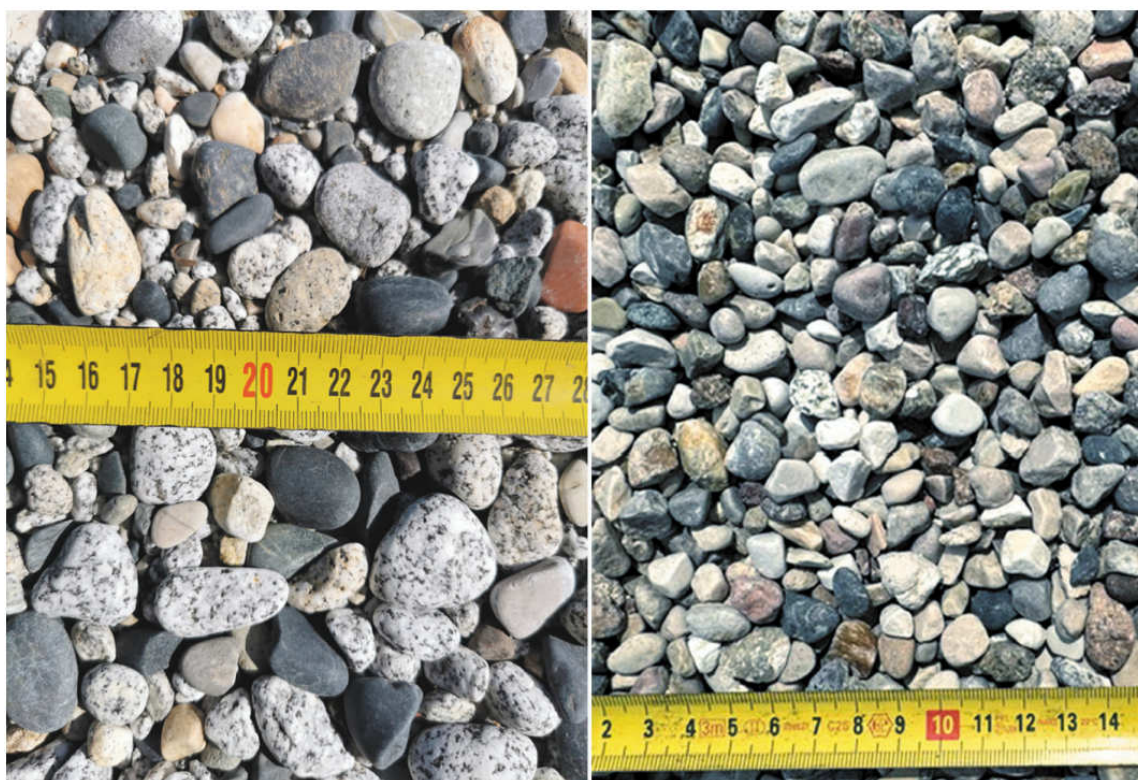
Fig. 19 – A destra un campione di sedimenti di spiaggia di Pomonte, con granuli di dimensione molto variabile (i grani sono stonati dall'azione delle onde, ma erano stati versati in spiaggia a spigoli vivi). A destra il ghiaietto stonato di fiume, di pezzatura media (fra 8 e 12 mm), molto simile per colore e composizione a quello presente in spiaggia.
