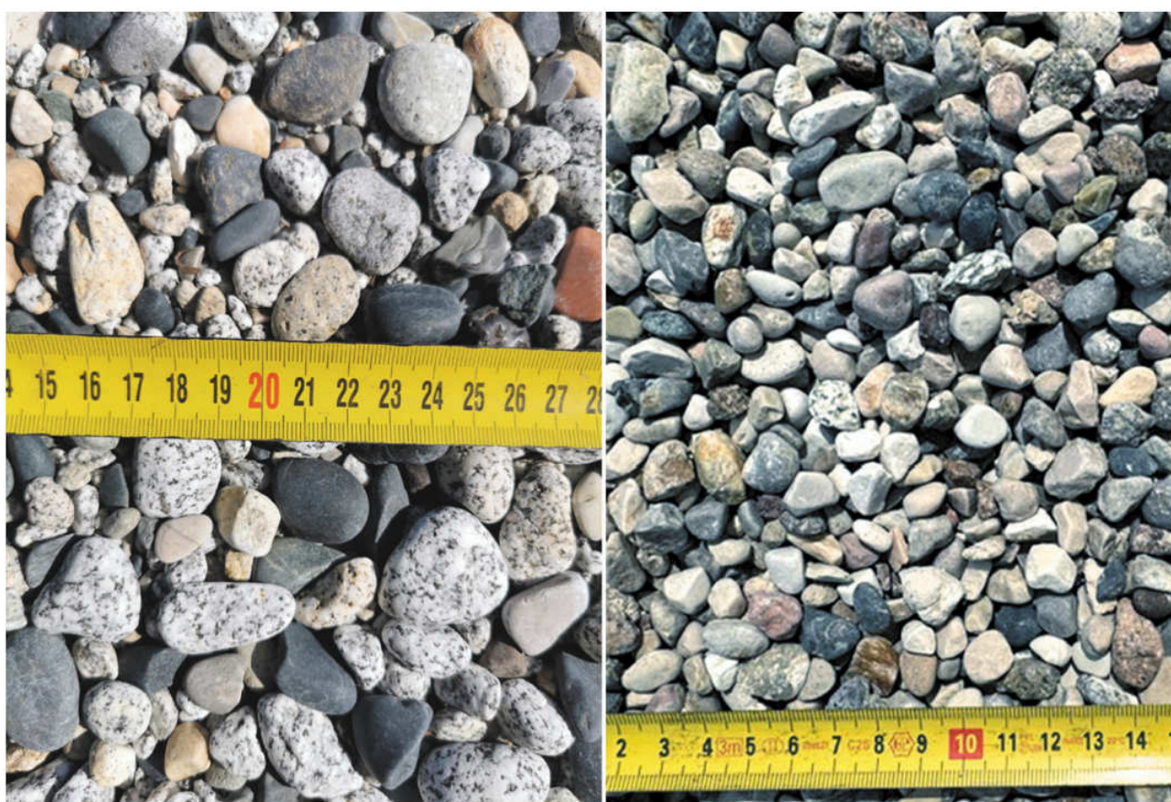
Fig. 6 – A sinistra un campione di sedimenti di spiaggia di Pomonte, con granuli di dimensione molto variabile (i grani sono stondati dall'azione delle onde, ma erano stati versati in spiaggia a spigoli vivi). A destra il ghiaietto stonato di fiume, di pezzatura media (fra 8 e 12 mm), molto simile per colore e composizione a quello presente in spiaggia.
