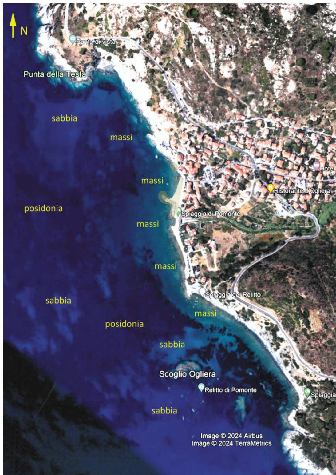
Fig. 8 – Il fondale davanti a Pomonte in una foto satellitare, molto contrastata per risaltarne composizione e biocenosi. Le opere di progetto (pennello e barriera radente) occupano una porzione minima della spiaggia sommersa più prossima alla riva . E si tratta di massi che si sovrappongono a massi, o ghiaie che si aggiungono a ghiaie, perfettamente compatibili e sovrapponibili.
