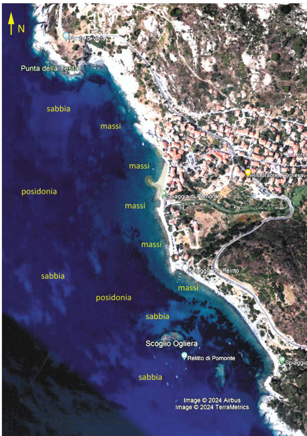
Fig. 3 – Il fondale davanti a Pomonte in una foto satellitare, molto contrastata per risaltarne composizione e biocenosi. Le opere di progetto (pennello e barriera radente) occupano una porzione minima della spiaggia sommersa più prossima alla riva. E si tratta di massi che si sovrappongono a massi, o ghiaie che si aggiungono a ghiaie, perfettamente compatibili e sovrapponibili.
