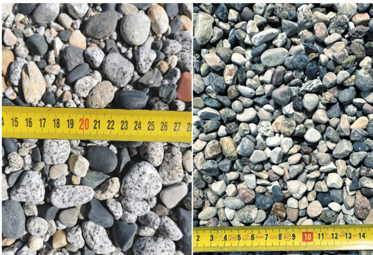
Fig. 3 – A destra un campione di sedimenti di spiaggia di Pomonte, con granuli di dimensione molto variabile (i grani sono stonati dall'azione delle onde, ma erano stati versati in spiaggia a spigoli vivi). A sinistra il ghiaietto stonato di fiume, di pezzatura media (fra 8 e 12 mm), molto simile per colore e composizione a quello presente in spiaggia.
